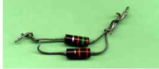
vista de dos resistores conectados en paralelo
